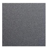
Grundmaterial pulverbeschichtet oder nasslackiert DB703.
