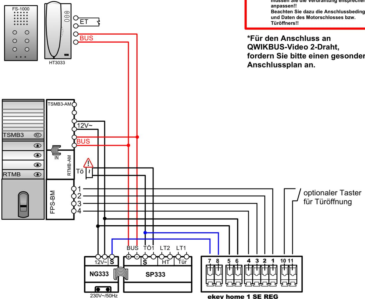
**!** Der Anschluss des Motorschlusses bzw. Türöffners ist hier nur als schematische Darstellung zu verstehen. In Abhängigkeit des Motorschlusstyps müssen Sie die Verdrahtung entsprechend anpassen!! Beachten Sie dazu die Anschlussbedingungen und Daten des Motorschlusses bzw. Türöffners!!
