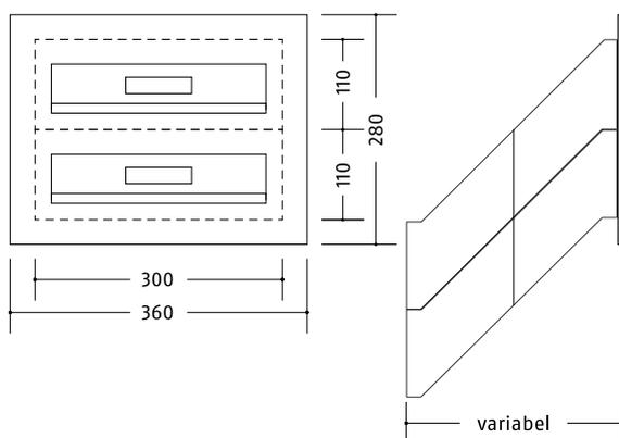
**Inoplan Standardanlagen Mauerdurchwurf, ohne Technikfach**
