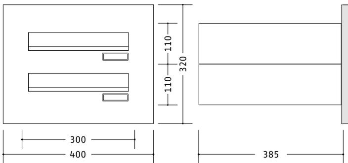
**Basic Edelstahl Standardanlagen für Türpaneel-Montage, ohne Technikfach**
