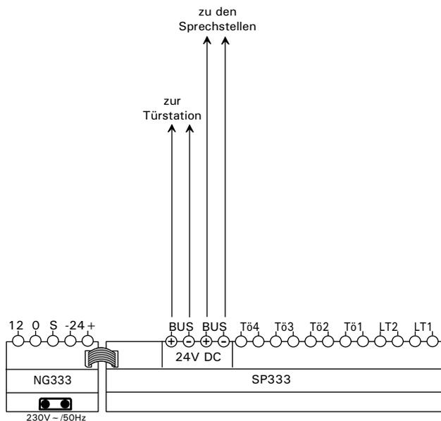
Elektrischer Anschluss (Beispiel Qwikbus- Videoanlage)
