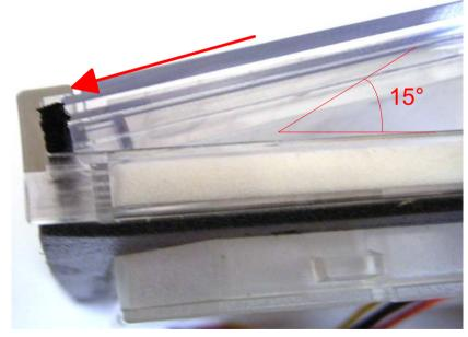
Taste im 15° Winkel unter Kante ansetzen und herunter drücken, bis diese einrastet.
