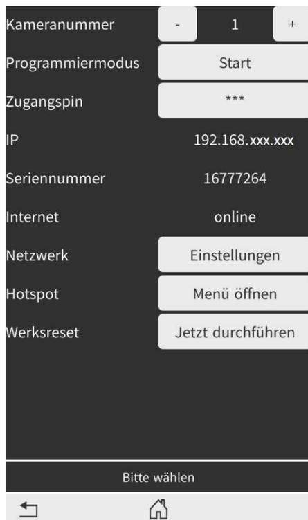
**Kameranummer:** An dieser Stelle kann die Kameranummer angepasst werden. Standard ist immer Kameranummer 1. Diese wird auch standardmäßig bei den Innensprechstellen zuerst gezeigt.
