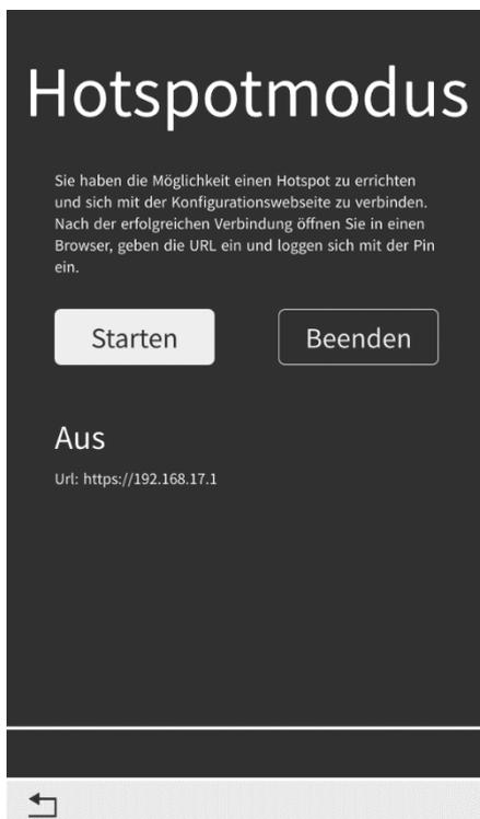
Sie haben die Möglichkeit am QSTT einen Hotspot zu aktivieren. Dieser ermöglicht es Ihnen, sich mit einem WLAN-fähigen Gerät an der Qwiksmart Touchtürstation anzumelden und somit Zugriff auf die Adminwebseite zu bekommen. Die Adminwebseite ist nicht zu verwechseln mit der Adminseite der QSTT. Mittels der Adminwebseite verwalten Sie sämtliche Einträge, Zusatzlizenzen und Einstellungen der Qwiksmarttouch Türstation.
