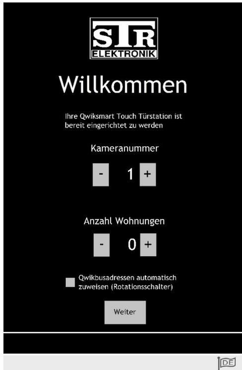
**Kameranummer:** Stellen Sie hier die gewünschte Kameranummer ein, in dem Sie auf die Plus- oder Minustaste tippen. Es können die Nummern 1-64 eingestellt werden. Standardmäßig ist immer die Kameranummer 1 vergeben. Zu einer Standard QwikBUS Anlage ist die Kameranummer mit den dort einstellbaren Türnummern vergleichbar. Wenn die QSTT Ihre Haupttür ist, empfehlen wir hier die Kameranummer 1 einzustellen bzw. stehen zu lassen.
