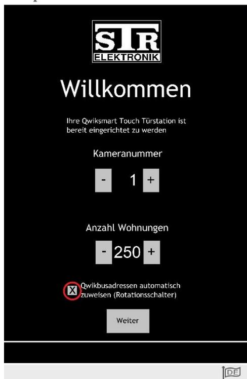
**Qwikbusadressen automatisch zuweisen:** Setzen Sie den Haken in dem Feld (siehe rote Markierung), wenn denen von Ihnen angelegten Wohnungseinträgen automatisch eine Qwikbusadresse zugewiesen werden soll. Beachten Sie aber, dass dies nur funktioniert, wenn die verwendeten Endgeräte über die *Rotationsschalter zur Adresseinstellung* verfügen.
