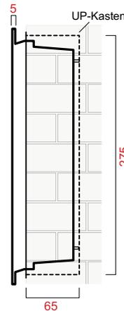
Abmessungen Hinterbau (in mm)
