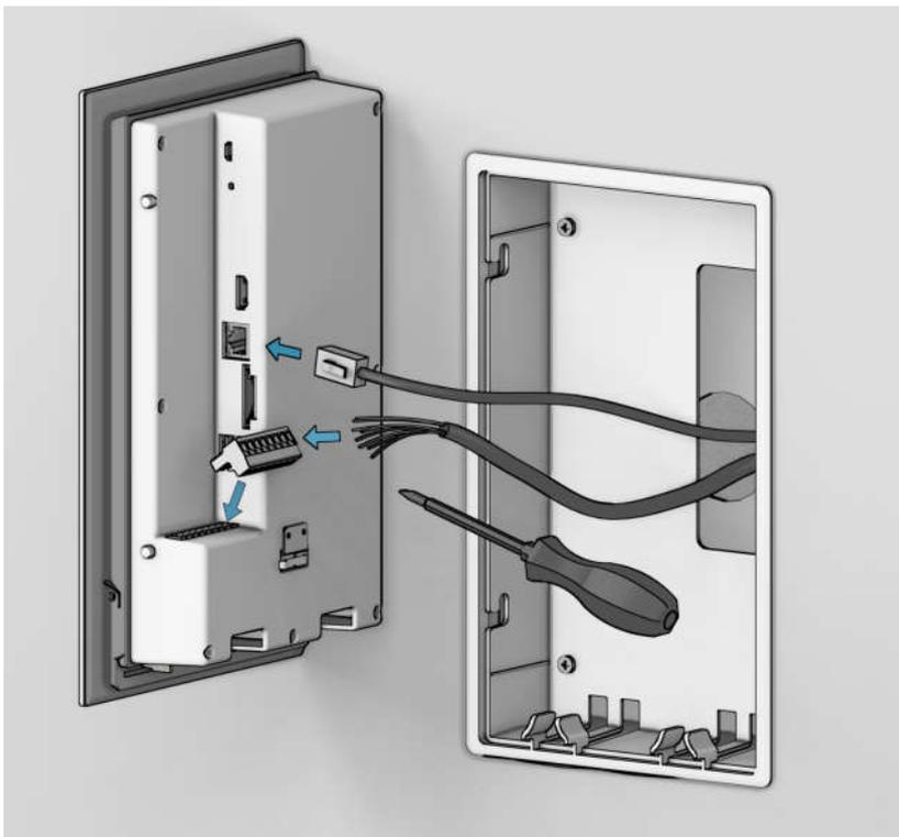
Schließen Sie das Anschlußkabel an den Steckverbinder an. Setzen Sie nun den Steckverbinder und das Netzwerkkabel in die Qwiksmart Touch 7 ein.
