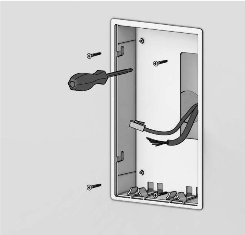
Anschließend befestigen Sie diesen mit den beiliegenden Schrauben. Dabei schließt er bündig mit der verputzten Wand ab.
