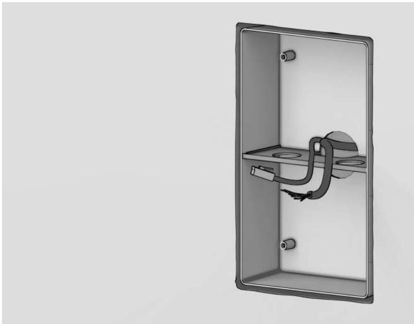
Führen Sie das Anschluß- sowie Netzkabel durch die Öffnung des Unterputzgehäuses hindurch.
