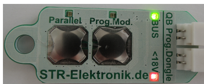
Busspannung unter 18V/DC (rote Led leuchtet), Programmierung nicht möglich/Fehler in Anlage
