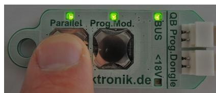
Taste "Parallel" betätigen, Anlage im Parallelprogrammiermodus
