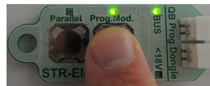
Taste "Prog.Mod." betätigen, Anlage im Programmiermodus
