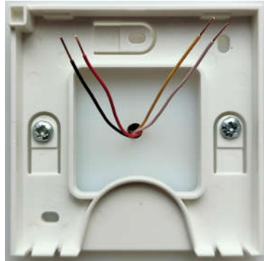
Abb. 2 Nun die Rückwand auf einer Schalterdose oder plan an der Wand montieren.
